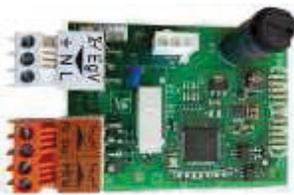
Platina para el control válvula de gas externa y presostrato.
