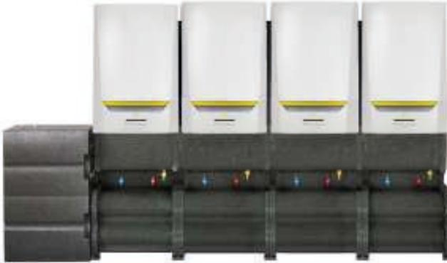
Sistema de distribución Paradigma para cascadas de calderas de hasta 4 PMA Maxi, que consiste en todos los componentes necesarios para el kit hidráulico de la cascada, junto con el aislamiento. El sistema es para el montaje de las calderas en pared. Posibilidad de conexión a derecha e izquierda. El kit hidráulico depende del número y la potencia de las calderas que lo componen.
