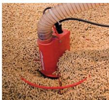
Consiste en un robot de aspiración de pelet que se desplaza por el silo
