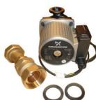
Bomba modulante clase A, distancia entre ejes de 130 mm (con kit para distancias entre ejes de 180 mm), que se instala en el exterior de la caldera (solo para PMA Maxi 45 y 65). Unión incluida.
