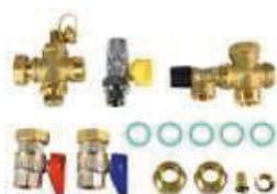
El suministro incluye: grifo de cierre para ida y retorno 1", grifo de gas 3/4" con unidad de cierre térmica integrada, grifo de carga en el retorno, conexión para vaso de expansión externo, válvula de seguridad de 4 bares.
